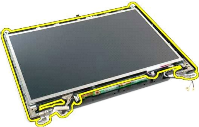
7. Verwijder het LCD-beeldschermpaneel uit het beeldscherm.
